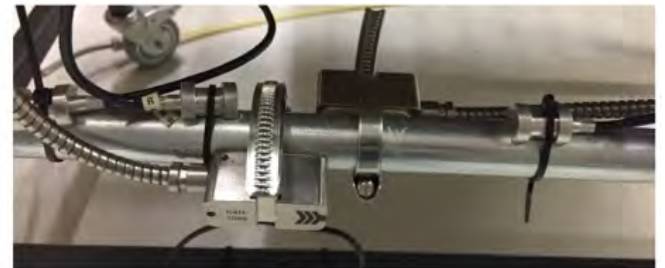
Figur 4.6: Flowtransducer og PT100 temperaturfølere.
