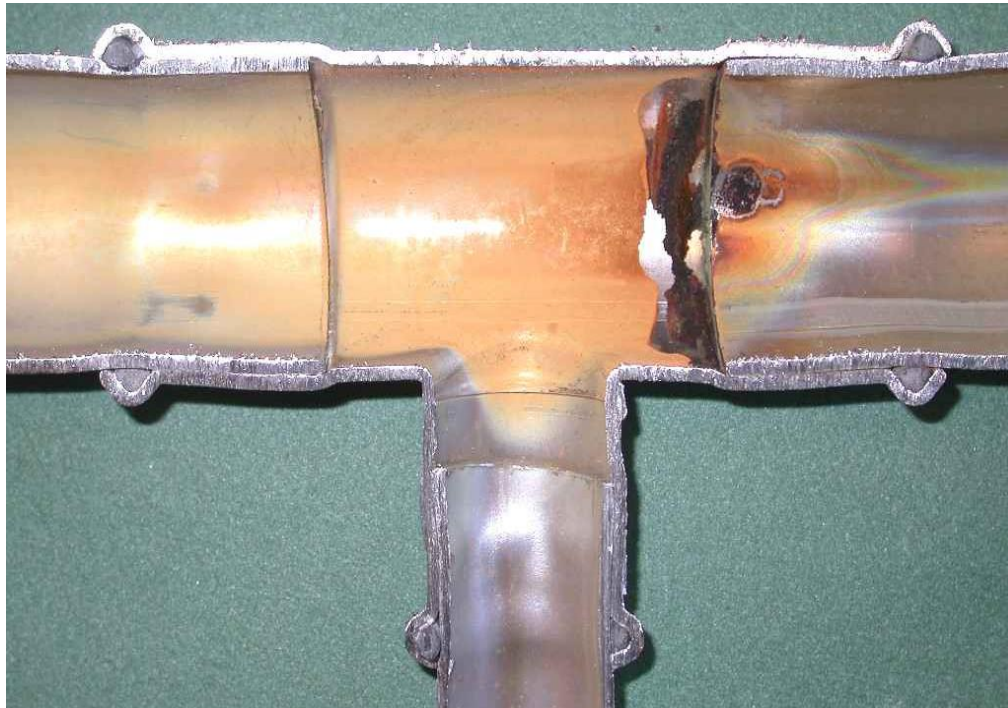
Spaltekorrosion, rør samlet med presfitting, AISI 316, Brugsvand
