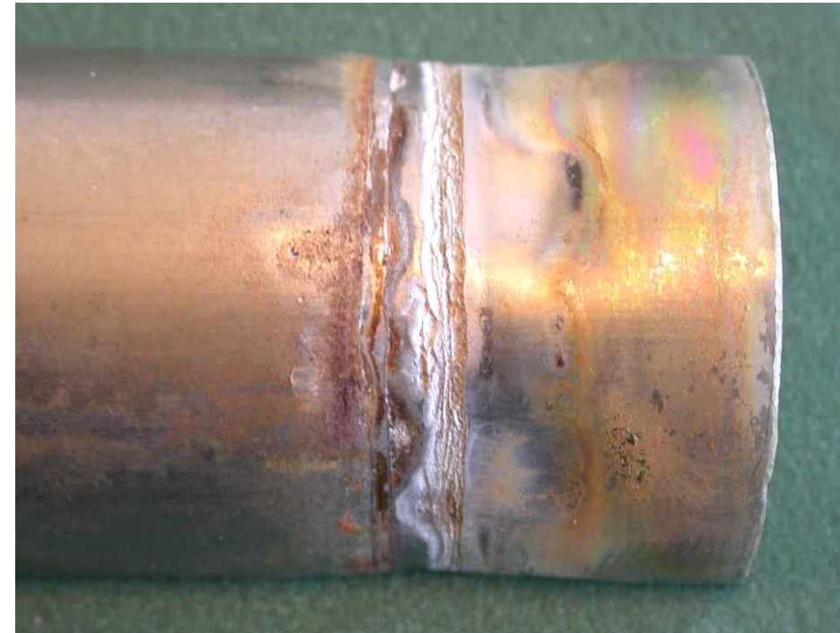
Spaltekorrosion, rør samlet med presfitting, AISI 316, Brugsvand
